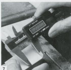
7 Kobberplaten deles inn i to deler med et skyvelære. Hver del på 22 mm.
